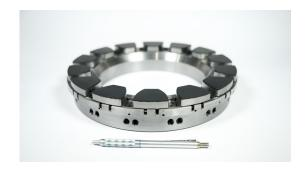
PEEK ist mit einer speziell entwickelten Schicht für das PEEK-Material mit dem Stahlträger verbunden. Unter Temperatur und Druck wird das PEEK fest in diese Schicht gepresst und bildet eine starke mechanische Verbindung, nach der es mit konventionellen Bearbeitungstechniken in das fertige Bauteil eingearbeitet wird.
