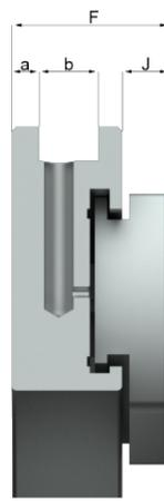
Druckring für „verlustarme“ Anwendung
