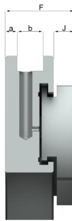
Druckring für „verlustarme“ Anwendung
